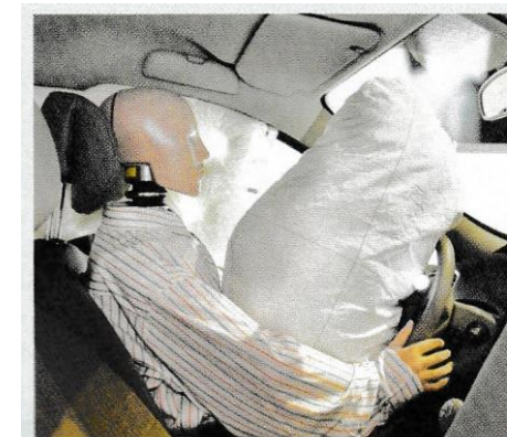
Airbag déployé à la suite d'un choc
